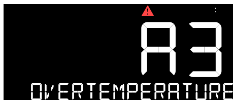
Fig. 34: Exemple : alarme de surchauffe A3 active
