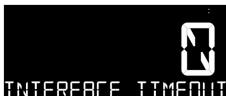
Fig. 24: Surveillance de la connexion dés-activée
