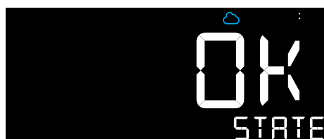
Fig. 30: Connexion existante, symbole Cloud dans la barre d'état
